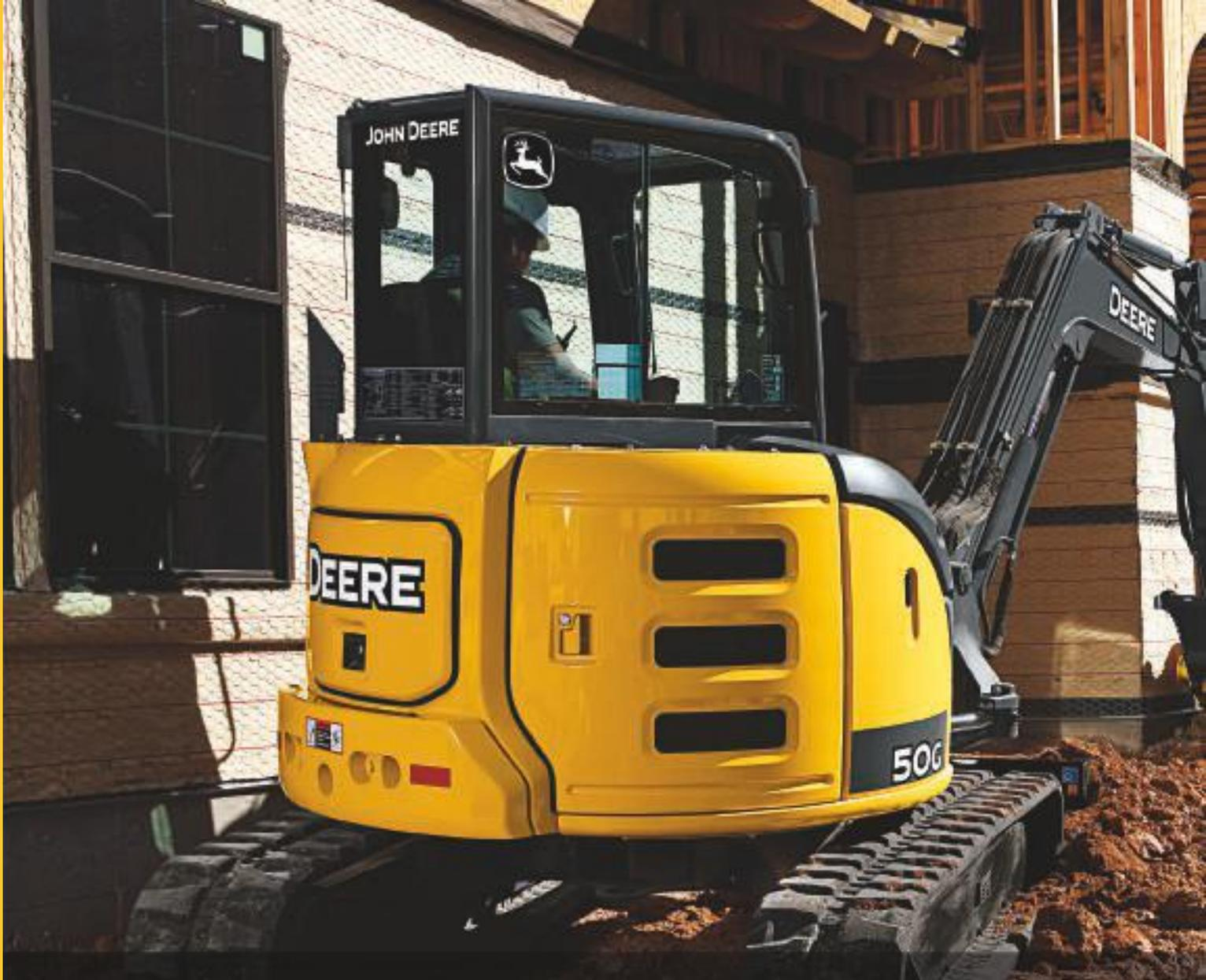
Los modos de trabajo de potencia/economía le permite igualar la velocidad del motor según la aplicación. Seleccione el modo de **Potencia** y obtenga las velocidades del motor más altas para realizar la mayoría de los trabajos generales de excavación. Para demandas de excavación livianas, el modo de **Economía** reduce la velocidad y el ruido del motor a la vez que mejora la economía de combustible.
